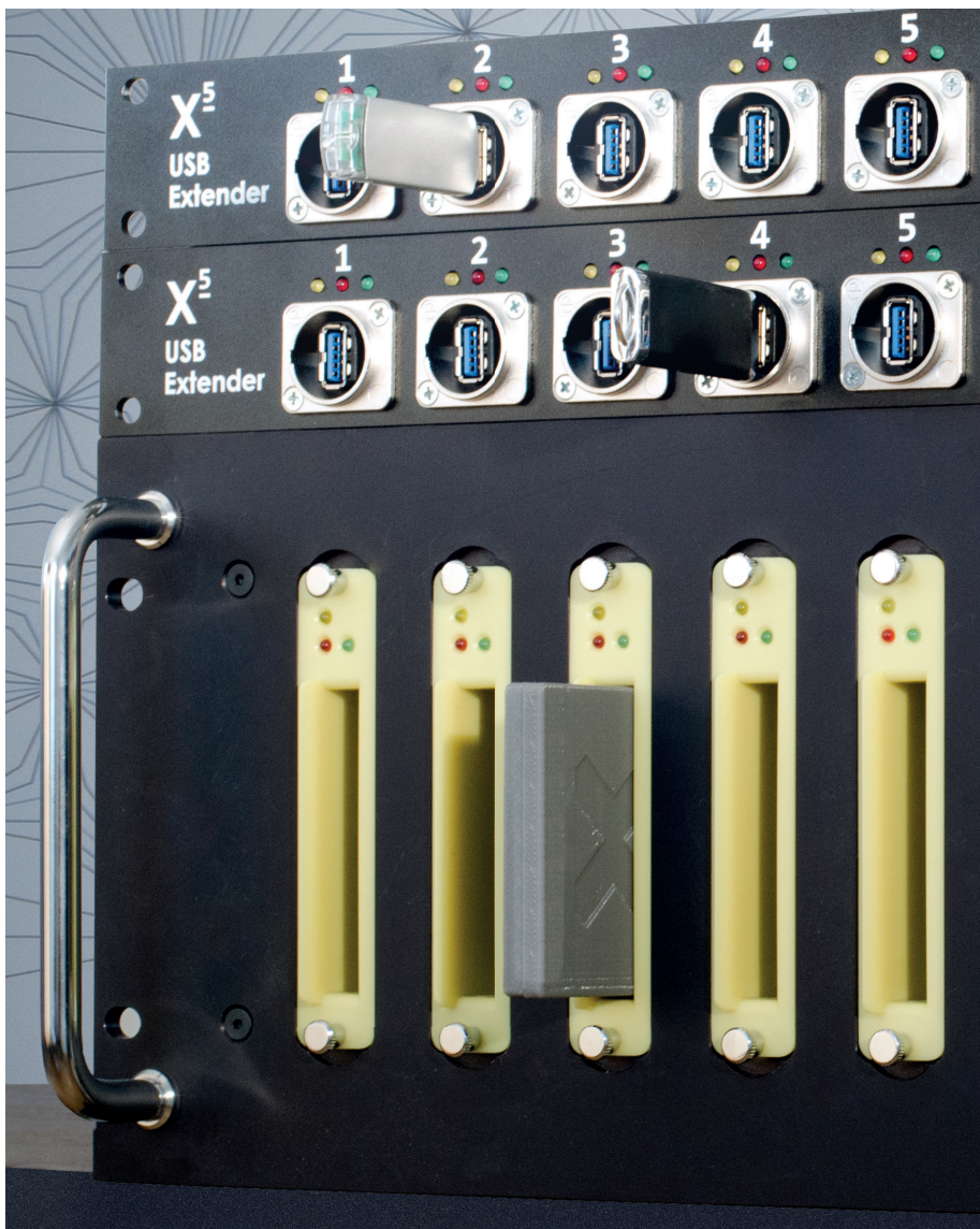
Ein X 5 System kann mit bis zu 8 (unterschiedlichen) Modulen ausgestattet werden.
